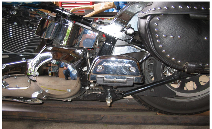
attaches arrières types; les photos démontrent les attaches arrières (du haut et du bas) de chaque côté de la motocyclette
