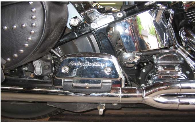
attaches arrières types; les photos démontrent les attaches arrières (du haut et du bas) de chaque côté de la motocyclette
