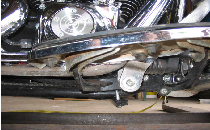
attache avant type; les photos démontrent une barre attachée aux deux tubes inférieurs du cadre de part et d'autre du cadre
